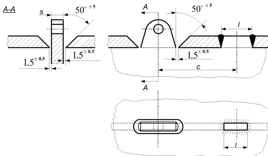
Fig. 2.2.5.1-1. Pin slot weld
