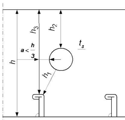
Fig. 3.4.3.5. Determining of web net height
