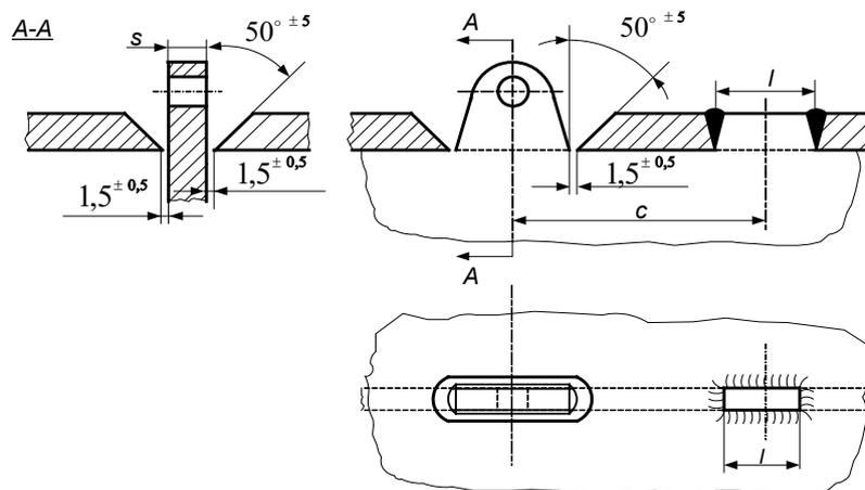
Fig. 2.3.2.5.1-1 Pin slot weld
