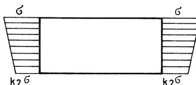
Fig. 2.5.7.5.2.1 Definition of coefficient  $k_2$
