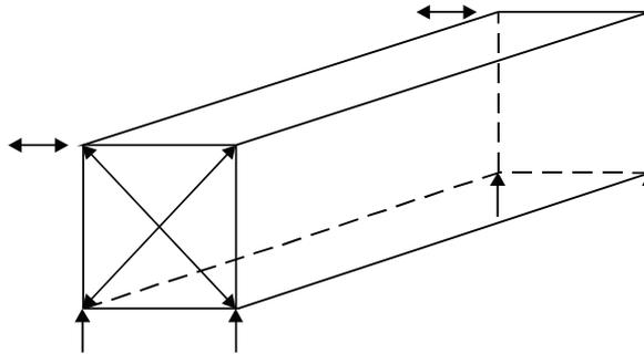
Fig. 3.6.1.1. Transverse rigidity test
