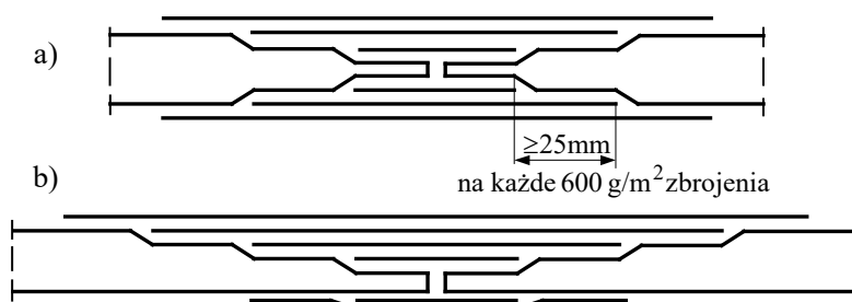
Rys. 9.2.10.2.1. Połączenia doczołowe z ukosowaniem elementów
