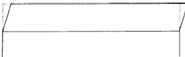
Rys.3.3-2 Odształcenia ramy poprzecznej spowodowane obciążeniem statku przechylonego
