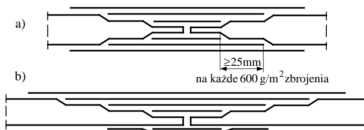
Rys. 9.2.10.2.1. Połączenia doczołowe z ukosowaniem elementów
