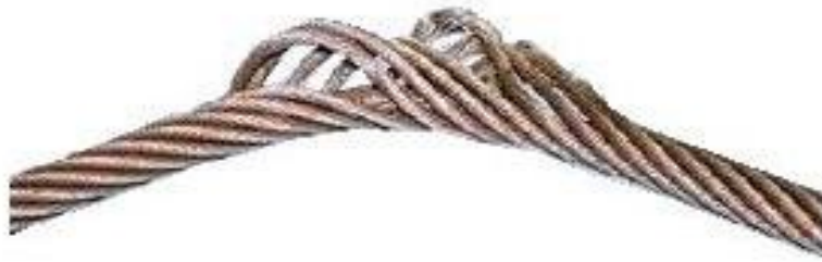
Rys. 9. Koszykowatość (ptasia klatka) – zniekształcenie lin wielosplotkowych konstrukcji – uzasadnienie natychmiastowej wymiany.
