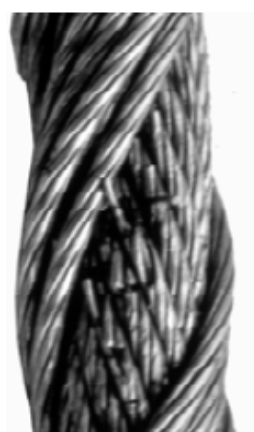
Rys. 7. Zerwane druty w warstwie wewnętrznej linii przeciwwzitej, spowodowane nagłym przeciążeniem – uzasadnienie natychmiastowej wymiany.
