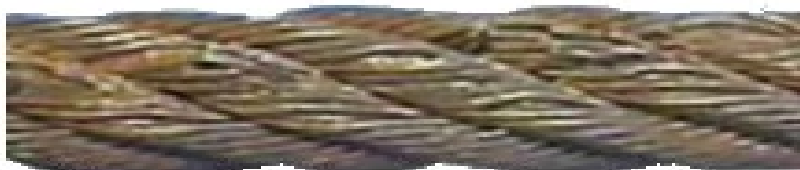
Rys. 5. Zerwane druty w kilku splotkach występuje w krążku wyrównawczym (często zakryte przez krążek) – uzasadnienie natychmiastowej wymiany.
