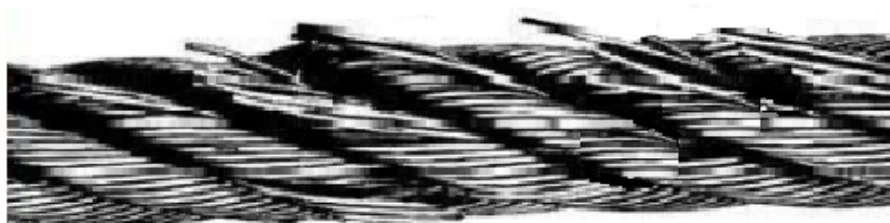
Rys. 1. Zerwane i wyciśnięte druty w sąsiednich splotkach liny przeciwwzitej – uzasadnienie wymiany.
