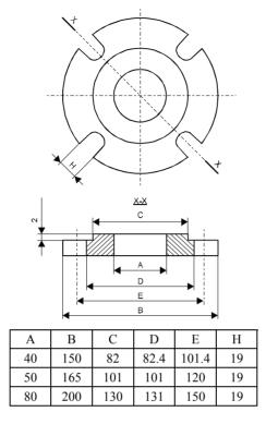
Fig. 2.5.5. Pipe flange dimensions
