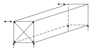
Fig. 3.6.1.1. Transverse rigidity test
