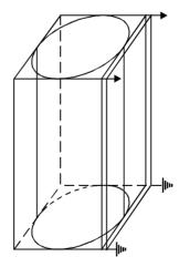
Fig. 3.4. Longitudinal strength test
